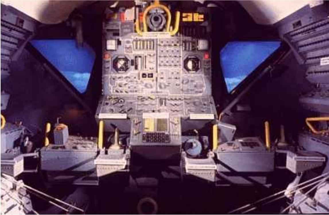
Im oberen Teil des Vorbaus befinden sich zwei Digital-Anzeigefelder. Darunter liegen (flache) Lampenfelder. Die Anzeigefelder sind eine frühe Form von LCD-Feldern und können nicht näher spezifiziert und zugeordnet werden. Die Zuordnung besorgen die flachen Lampenfelder. Man beachte die gerade noch erkennbare Symbolik auf den Lampenfeldern.
